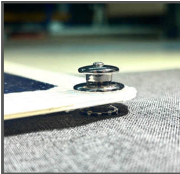
Panel Ve Tekstil Yüzeyindeki Çıtçıt Parçalarının Birbirine Geçirilerek Kilitlenmesi
