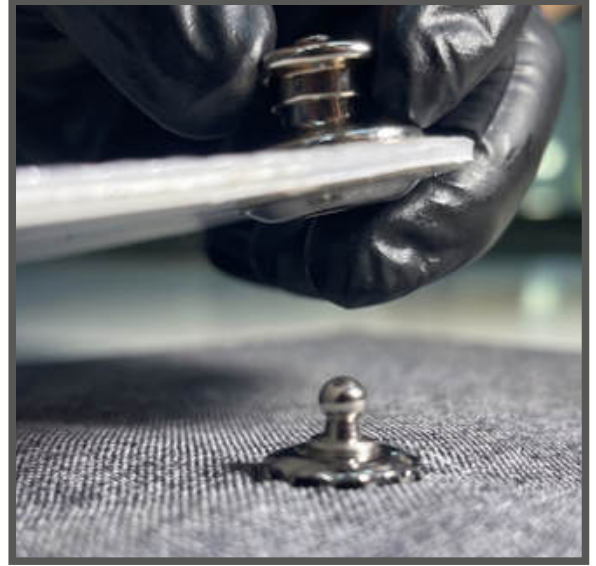
Panel Üzerindeki Üst Çıtçıt Parçasının, Tekstil Yüzeyindeki Alt Çıtçıt Parçasına Hizalanarak Yerleştirilmesi
