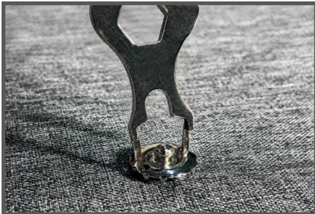
Sökülen Parçanın Özel Uç Yardımı İle Yeniden Takılması
